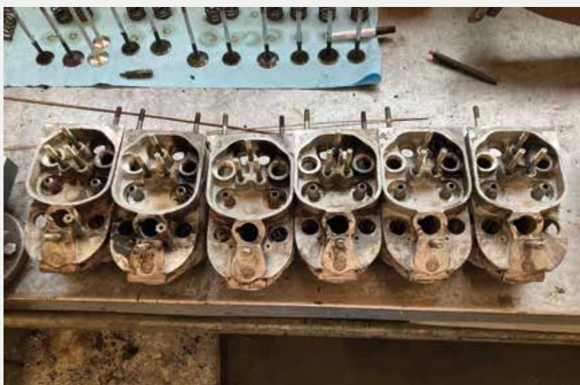
Für die Reparatur mussten unter anderem die Zylinderköpfe demontiert werden.
