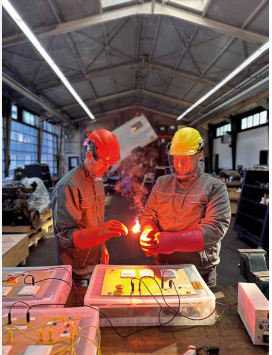
Spannung auf höchstem Niveau: Der erzeugte Lichtbogen zeigt eindrucksvoll, welche Leistung in einer Batterie steckt, die aus mehreren handelsüblichen 9-Volt-Blocks besteht.
