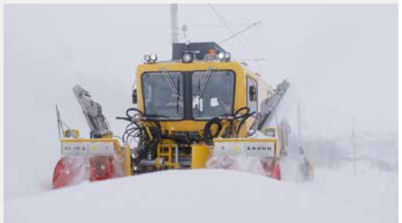
Der MPV VentuS Typ GAF mit diesel-elektrischen Antrieb und Traktionsbatterie (oben). Windhoff Energiemodul DE 520kW EU StageV NRE für den MPV VentuS (Mitte). Einsatz unter widrigsten Bedingungen - der MPV VentuS Typ GAF Polar (unten).
