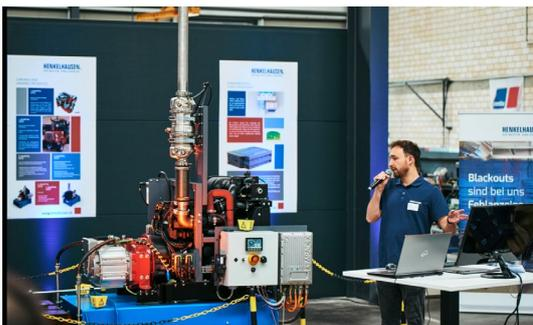
Joscha Schröder, Systemingenieur Alternative Antriebe, präsentiert: Hybrider Antriebsstrang für Off-Highway Maschinen basierend auf einem Elektro- und Dieselmotor aus dem Hause HENKELHAUSEN. Beide wirken parallel auf einen Abtrieb und sind dabei immer aktiv. Klarer Vorteil: Effizienzgewinn, leiserer Betrieb und mehr Spitzendrehmoment bei Bedarf.
