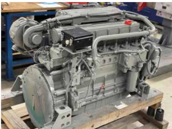
**Wieder wie neu: Ein DEUTZ-Motor BF6M 1013MCP in Marineausfertigung nach erfolgter Motorrevision durch HENKELHAUSEN.**
